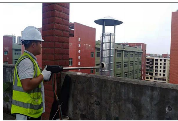
浸锡废气出口采样照片
