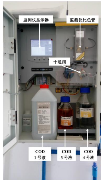
图 4-8 COD 在线监测仪内部组件
